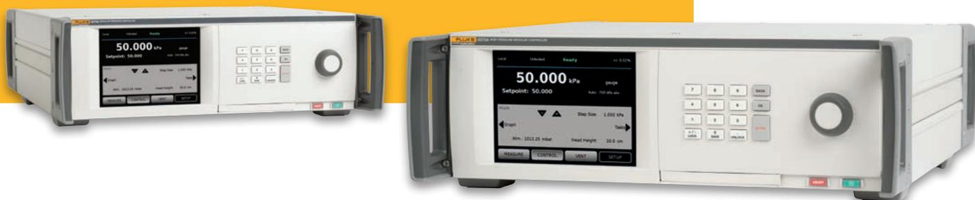
Les contrôleurs de pression pneumatiques automatiques 8270A et 8370A permettent d'étalonner de nombreux capteurs de pression puisqu'ils couvrent des plages de pression deux fois plus étendues deux fois plus rapidement que les autres contrôleurs de pressions élevées. Les deux modèles offrent un rapport prix/performance intéressant :
